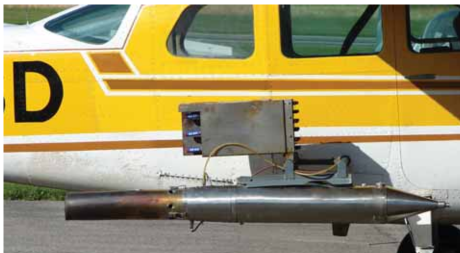
Figure 3.13 Cet avion monomoteur Cessna 210 est équipé d'un générateur d'iodure d'argent. Il est conçu pour réaliser des expériences d'ensemencement des nuages.
